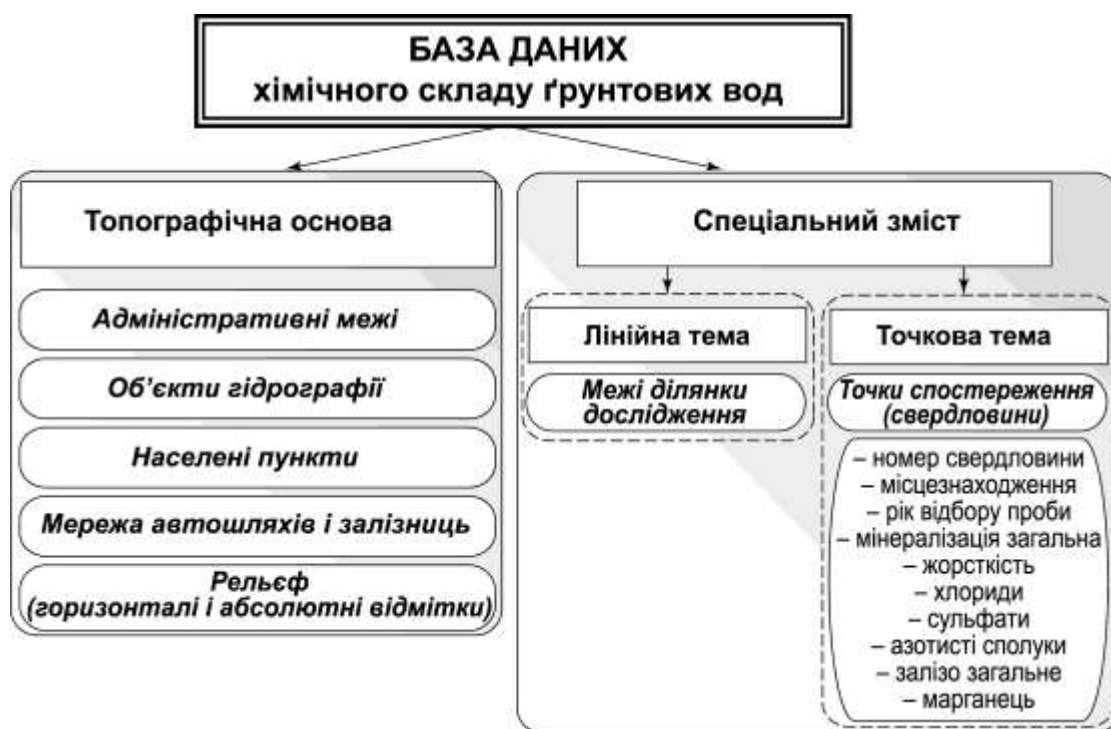
Рис. 2.6. Структурно-графічна модель спеціалізованої бази даних хімічного складу ґрунтових вод
