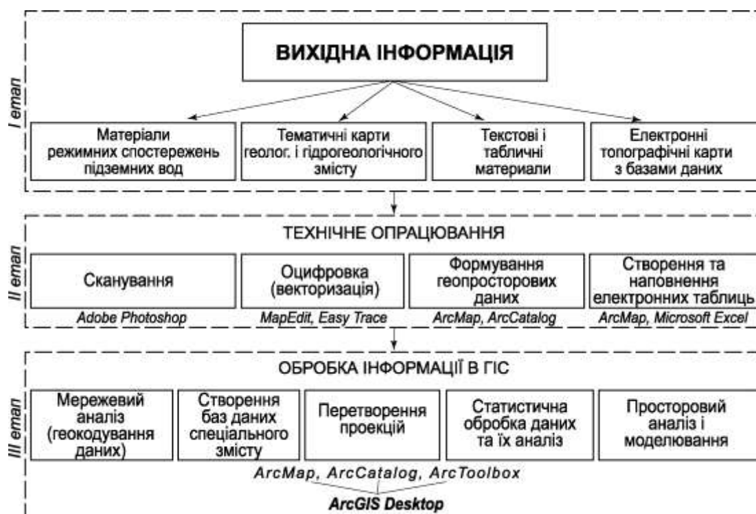
Рис.2.1. Загальна технологічна схема опрацювання вихідної гідрогеологічної інформації
